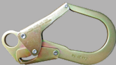
GANCHO DE 2 1/2" DE APERTURA DE COMPUERTA RESISTENCIA DE COMPUERTA DE 3600 lbs
